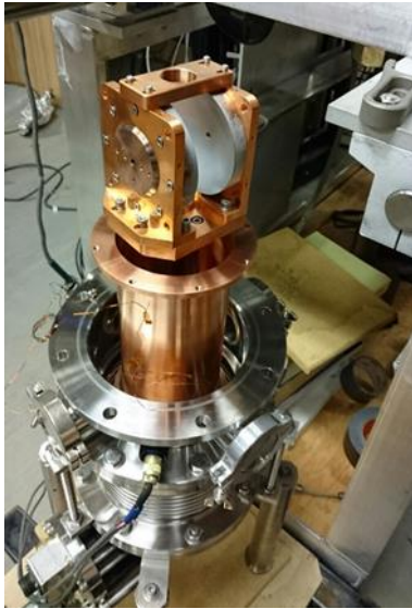
شکل ۱: تشدیدگر فابری-پرو ابر رسانا از جنس مس و لایه نشانی Pb-Sn.
