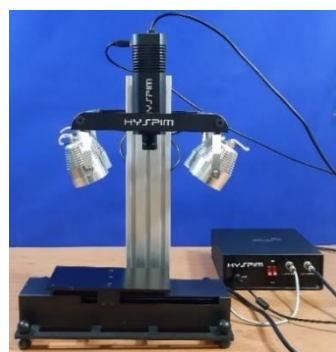
شکل ۱: تصویربردار فراطیفی همراه با اسکنر خطی.
