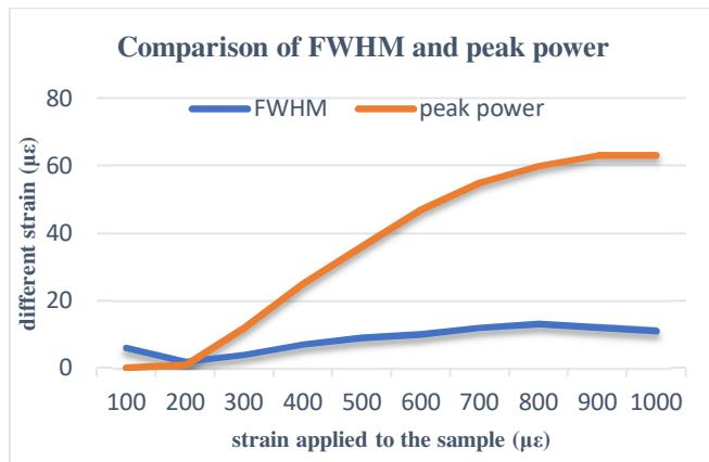
شکل ۲- نمودار فیت شده دو روش FWHM و توان پیک بازتابی با توجه به جدول ۱
