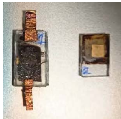
شکل ۱: مقایسه سلول کپسول شده (۱) و سلول رفرنس (۲) بعد از اعمال رطوبت 85% RH و حرارت 85 °C
