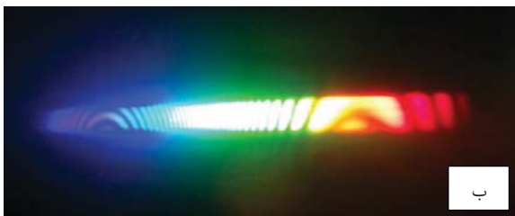
شکل ۳: الف) طرحی از حضور لامل به صورت نیمه در مسیر نور. ب) طرح تداخلی دو بیم I و II در طیف سنچ.
