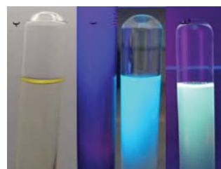
شکل ۳- خاصیت لومینسانس (الف) نمونه اول و (ب) نمونه دوم تحت تابش نور فرابنفش. (پ) محلول در نور مرئی
