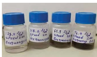
شکل ۴. نمونه‌های کلئید نانوذرات پلاتین در شاریدگی‌های مختلف
