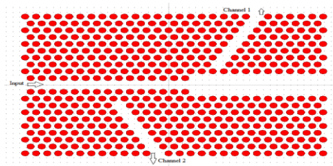
شکل ۲. ساختار پیشنهادی دیمالتی پلکسر
