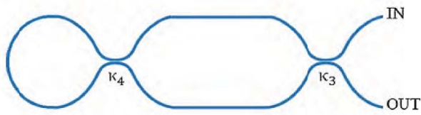
شکل ۱: طرح نمادین تداخل سنج ماخ-زندر با حلقه ساینک [۱].
