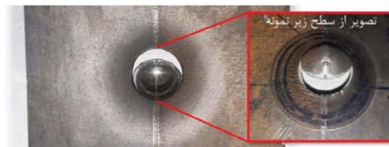
شکل ۵: تست اریکسون از جوش نمونه ۹ متناظر با جدول ۱.
