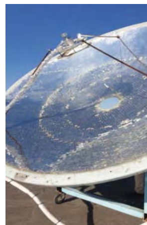
شکل ۷: بشقاب جمع‌کننده خورشید و سامانه لیزری از جلو.
