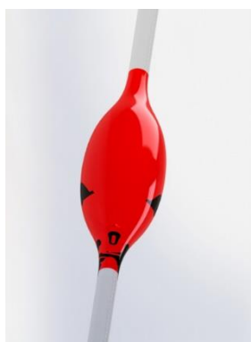
شکل ۱ : طرح واره میکرو لیزر های بطری شکل که در دیواره فیبر نوری تشکیل شده اند
