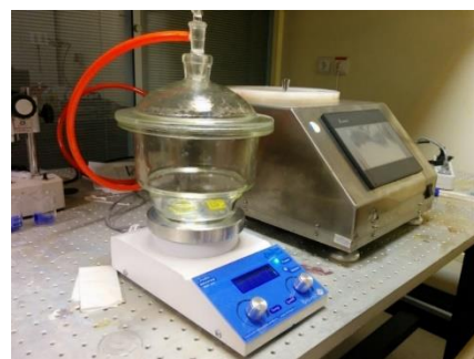
شکل ۶: سیستم خلأ مورد استفاده برای گرم کردن فیلم‌های لایه-نشانی شده چرخشی
