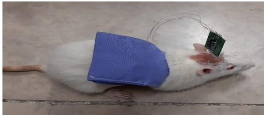
شکل ۲: تصویر ثبت الکتروفیزیولوژی بی سیم از حیوان در حال حرکت، با استفاده از باتری قابل حمل
