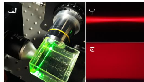
شکل ۵: کیفیت ورق نوری تولید شده. الف) شکل باریکه درون محلول صابون. ب) شکل باریکه درون محلول ردآمین قبل از شروع روبش. ج) شکل ورق نوری تشکیل شده در اثر روبش سریع باریکه
