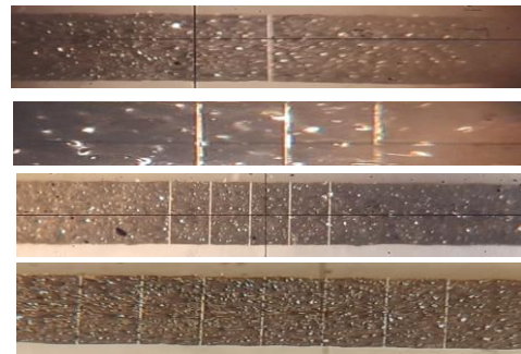
شکل ۲: نمایش میکروسکوپی خطوط لیزر بر روی نوارهای مغناطیسی، یک، سه، پنج و هفت شیار
