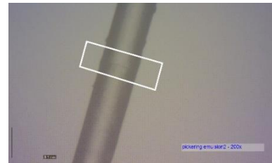
شکل ۲. تصویر میکروسکوپی محل اتصال دو نوع فیبر
