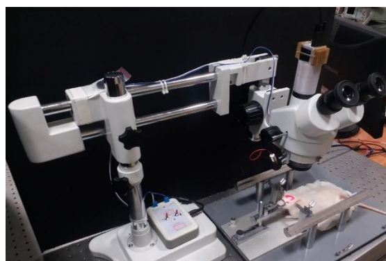
تصویر ۲: سیستم تصویربرداری کانتراست اسپکلی لیزری
