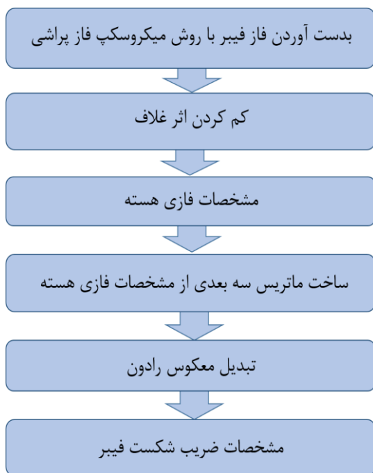
شکل ۱- روش بدست آوردن پروفایل ضریب شکست فیبر
