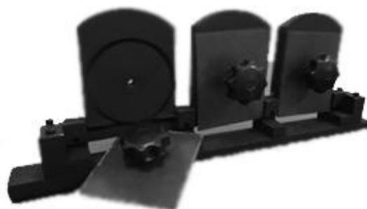
شکل ۸: دستگاه کنترل کننده قطبش فیبری مکانیکی ۳- صفحه‌ای ساخته شده.
