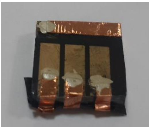
شکل ۲: تصویر سلول خورشیدی پروسکایتی پس از اتصال چسب مس و لاک نقره
