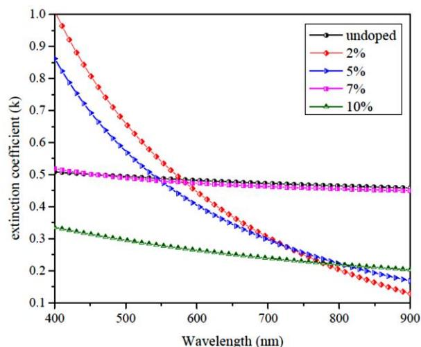
شکل ۶. تغییرات ضریب خاموشی بر حسب طول موج فیلم‌های نازک  $\text{Sb}_2\text{S}_3$  غیرآلایده و آلایده شده با درصدهای مختلف روی
