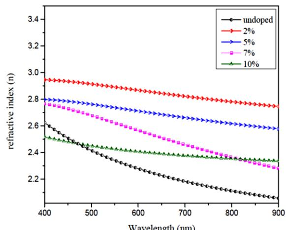
شکل ۵. تغییرات ضریب شکست بر حسب طول موج فیلم‌های نازک  $\text{Sb}_2\text{S}_3$  غیرآلایده و آلایده شده با درصدهای مختلف روی
