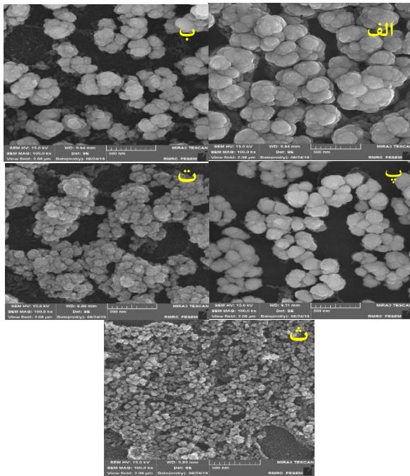
شکل ۲. (الف) تصاویر FESEM فیلم‌های نازک  $Sb_2S_3$  غیرآلاییده و (ب) آلاییده شده با عنصر روی ۲٪ (پ)، ۵٪ (پ)، ۷٪ (ت) و ۱۰٪ (ث) در مقیاس ۵۰۰ nm
