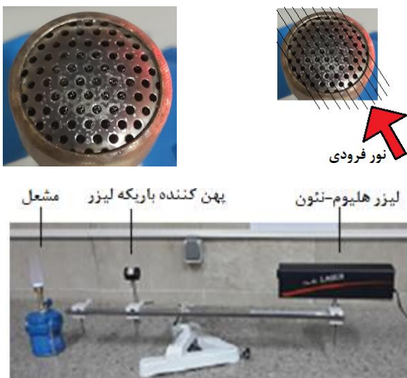
شکل ۱: (بالا) عکسی از سر مشعل که دارای منافذ متعدد است. (پایین) عکسی از چیدمان آزمایش برای بررسی انتشار نور لیزر هلیوم-نئون از یک دسته شعله گاز بوتان-پروپان.
