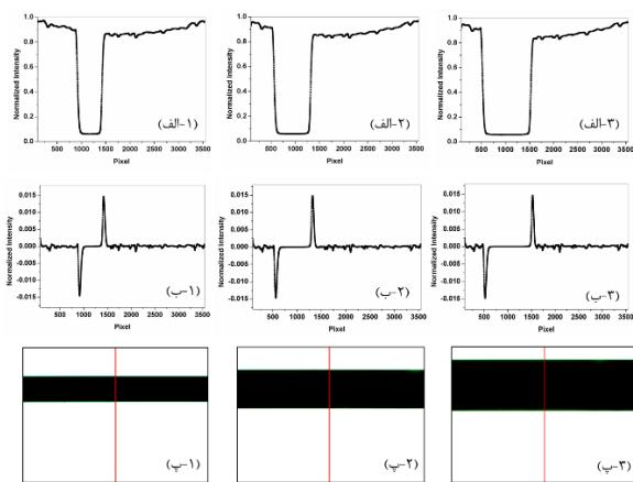
شکل ۵. سیگنال جسم (الف)، سیگنال مشتق (ب) و تصویر آشکارساز ماتریسی (پ) مربوط به جسمی به قطر  $\frac{3}{3} ۹۹۲$  میلیمتر (۱) جسمی به قطر  $۵\frac{۹}{۹} ۴$  میلیمتر (۲) و مربوط به جسمی به قطر  $۷\frac{۹}{۸} ۶$  میلیمتر (۳).
