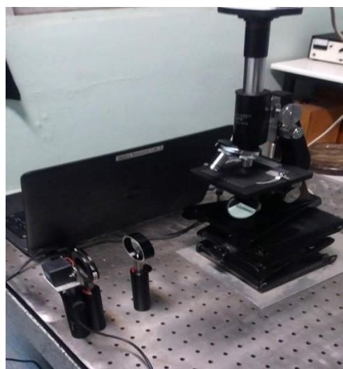
شکل ۲: چیدمان میکروسکوپی فازی به روش پراش فرنل
