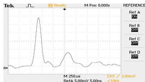
شکل ۵: تپ خروجی لیزر برای سامانه‌ی اپتیکی ۲۰-۲۰
