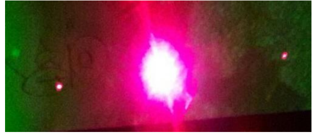
شکل ۴: طرح پراشی مرتبه اول لیزر هلیوم-نئون ناشی از توری هولوگرافی ایجاد شده بر روی نمونه پلیمری
