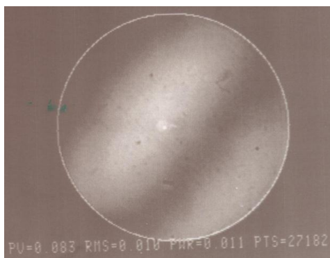
شکل ۶، چیدمان اندازه‌گیری دقت تختی جبهه‌ی موج در مبدل طراحی شده
