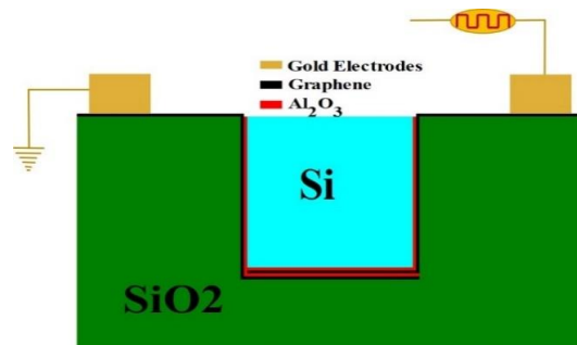
شکل ۱- نمای عرضی ساختار موجبر مدفون شده با لایه های گرافن بر روی دیواره های جانبی و کف آن به عنوان مدولاتور غیر حساس به قطبش
