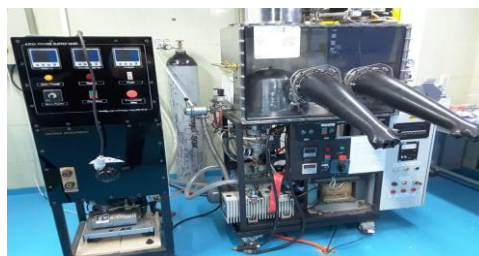
شکل ۳: دستگاه لایه نشانی تحت خلا در محیط گاز خنثی آرگون
