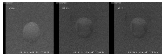
شکل ۳: تصاویر SEM مربوط به نقص‌های کلوخه‌ای به وجود آمده بر روی سطح نمونه‌ها
