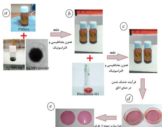
شکل ۲: مراحل ساخت فیلتر پلیمری
