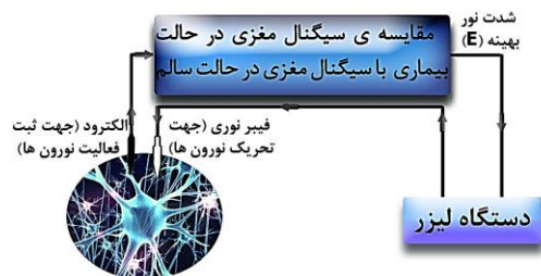
شکل ۱: شماتیک کنترل فعالیت های نورونی در حالت بیماری با استفاده از تکنیک اپتوژنتیک به صورت حلقه-بسته
