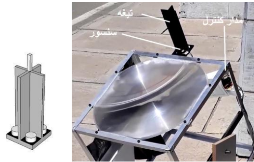
شکل ۱- مدار کنترل و حسگر سامانه ردیاب
