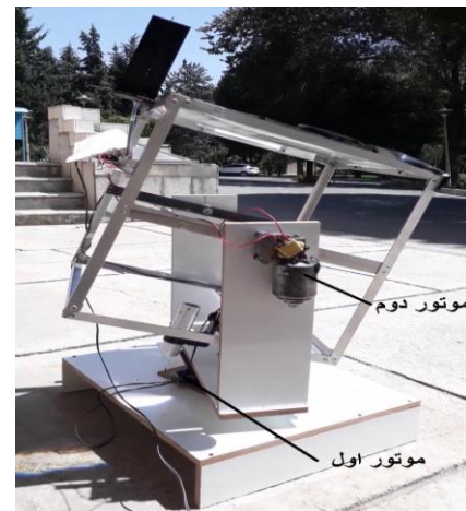
شکل ۲- ساختار مکانیکی ردیاب
