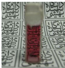
شکل ۲: کوت حاوی محلول رنگینه N719 که نمونه فوتو آند در آن قرار دارد.
