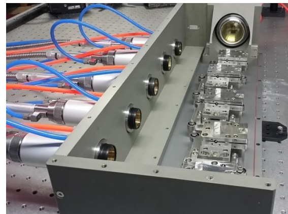
شکل ۷: نمایی از چیدمان ترکیب آرایه‌ای پرتوهای لیزر فیبری با استفاده از منشورهای راست‌گوشه قرار گرفته بر روی نگهدارنده‌هایی با ۵ درجه آزادی.
