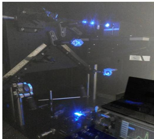
شکل ۳: تصویری از چیدمان تداخل دوباریکه ای در هنگام نوشتن توری
