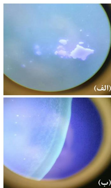
شکل ۴: تصویرهای ثبت‌شده از نقطه‌های کوانتومی کادمیم سلینید برانگیخته با طول‌موج ۴۰۵ نانومتر در محلول رودامین؛ در شکل (الف) تجمع نقطه‌های کوانتومی چسبیده به سطح زیرلایه و (ب) مرز زیرلایه-نمونه قابل مشاهده است.
