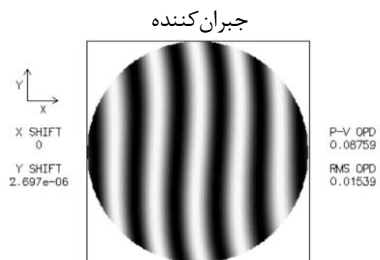
شکل ۸: الگوی تداخلی در نتیجه‌ی اعمال خطا به میزان 0.008333'' = 30\text{arcsec} در هم‌مرکزی عدسی جبران کننده
