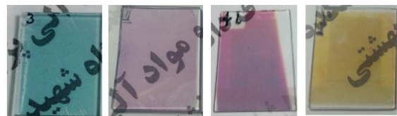
شکل ۱: به ترتیب از چپ به راست: نمونه ی طلا قبل از گرما، نمونه ی طلا بعد از گرما، نمونه ی نقره قبل از گرما، نمونه ی نقره بعد از گرما.
