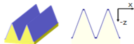
شکل ۱: سمت چپ شکل کلی ساختار، دیواره ها با زاویه دندانها ۷۷ درجه و لایه پوششی به اندازه ۳ نانومتر می باشد. شکل سمت راست سطح مقطع موجبر در صفحه XZ را نشان می دهد.
