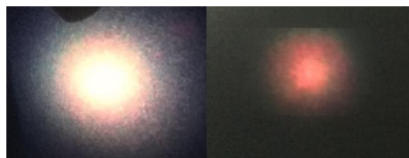
شکل ۳: عکس ابرپیوستار تولید شده توسط باریکه با انرژی ۶۶ میکروژول (راست) و انرژی ۰/۶ میلی ژول (چپ).
